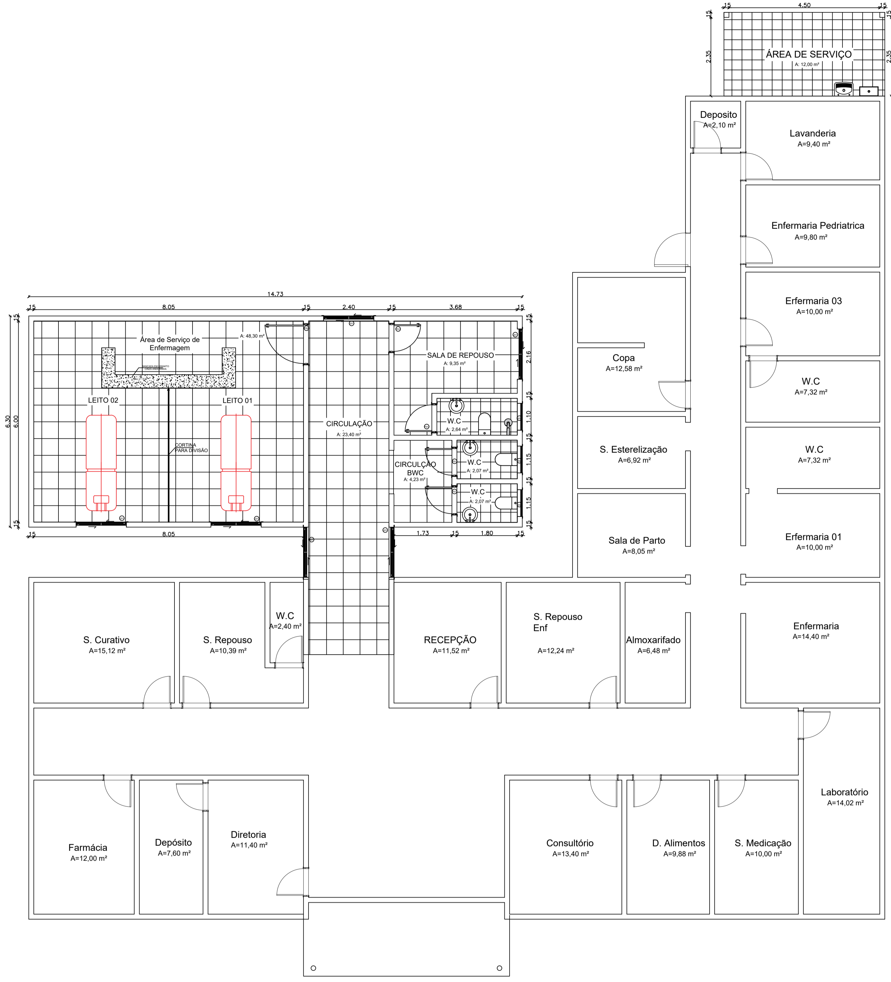
01 - PLANTA DE AMPLIAÇÃO ESC - 1:100
